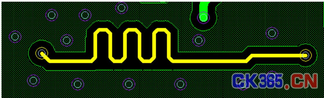
第二种环路, 出现在板级连接的场合。如智能机顶盒产品, 在 STB 主板和 EOC 主板或者 WIFI 模块连接时, 会在 GND 链路形成一个板级环路。可以在 GND 中间串接一个电感或者铁氧体磁珠进行隔离。
